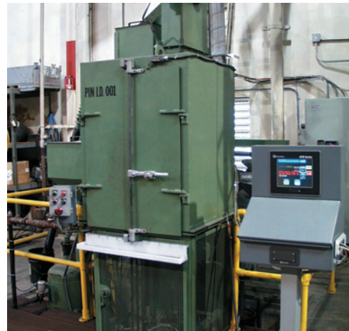
FIGURE 12-10A Machine auto-contrôlée à lance pour shot peening des alésages.
