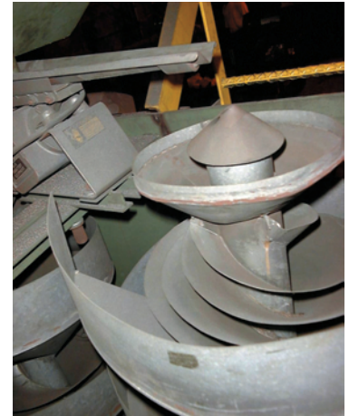
FIGURE 12-4 Système de tri pour billes de shot peening.
