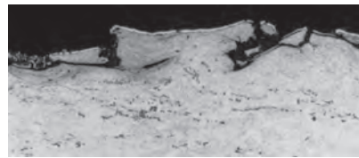
FIGURE 12-2A Endommagement en surface créé par des billes cassées.
