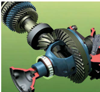
FIGURE 4-2 Montage couronne et pignon.
