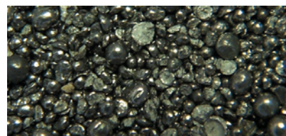
FIGURE 12-3B Billes inacceptables de mauvaise qualité.
